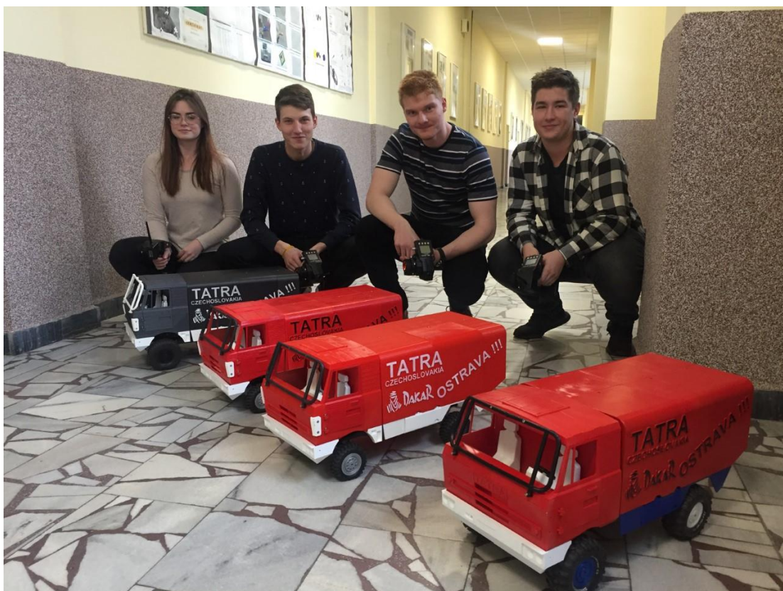
Studenti 3. ročníku s RC ovládacími modely vozu Tatra 815 Dakar, vytištěnými na 3D tiskárně.
